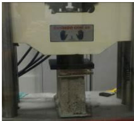
Figura 4 – Ensaio de resistência à compressão axial
